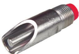
Der Beißnippel 1/2" ist ein hochwertiger und langlebiger Tränkenippel und speziell für Mastschweine geeignet. Das Trinkwasser wird freigegeben, sobald die Tiere gegen das Druckstück drücken.
